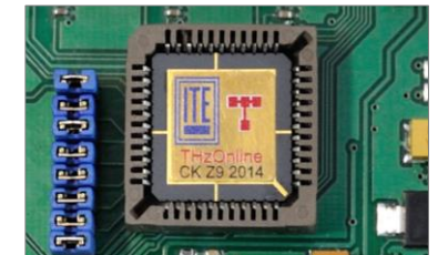
Scalony wielokanałowy układ odczytowy do tranzystorowych detektorów THz (AMS 350nm)
