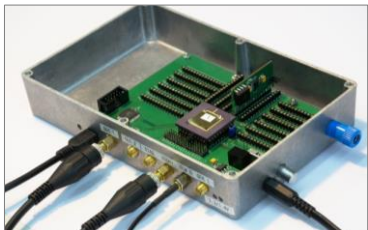
Środowisko testowe scalonego układu odczytowego licznika cząstek
