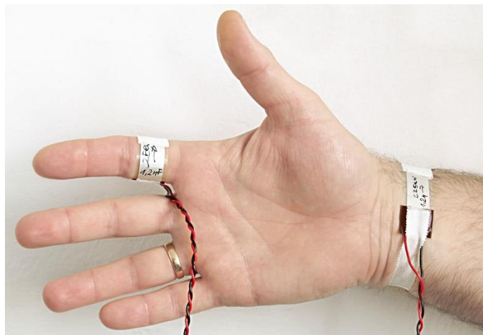
Rys. 3 Rozmieszczenie czujników do pomiaru fali tętna.
