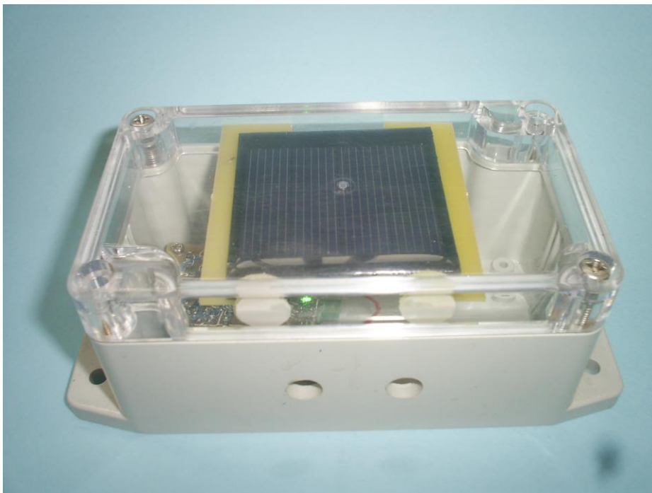
Rys 7. Układ zasilający (harwester) z klasycznym ogniwem fotowoltaicznym.
