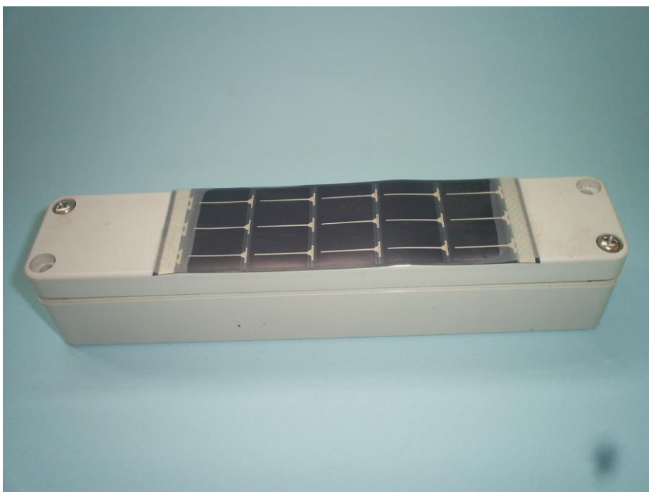
Rys 8. Układ zasilający (harwester) z elastycznym ogniwem fotowoltaicznym.
