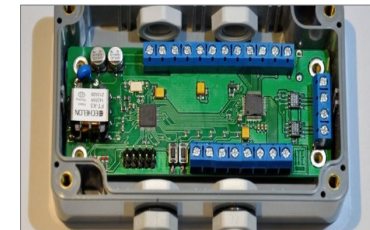
Moduł czujników temperatury – element sieci do wielopunktowego pomiaru RH i T w budynkach
