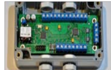
Moduł czujników temperatury – element sieci do wielopunktowego pomiaru RH i T w budynkach
