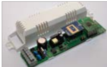
Sterownik inteligentnej oprawy oświetleniowej
