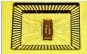
Scalony układ odczytowy licznika cząstek (UMC 180nm)
