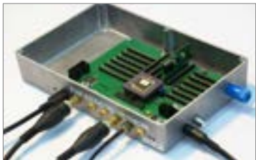
Środowisko testowe scalonego układu odczytowego licznika cząstek
